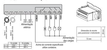
**Nota:** O comprimento do cabo do sensor pode ser aumentado pelo próprio usuário até 200 metros, utilizando cabo PP 2 x 24 AWG.
